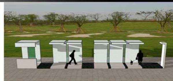
**组合：**车站由多个L型单体组合而成，数量视车站规模而定。地面为清水混凝土块与磨圆的青砖拼合而成，产生现代与传统的对话。
